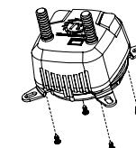
Fixez les clips de fixation Intel (A) sur le waterblock avec les vis (D).
