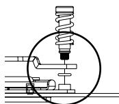
Assemblez les vis (F), les ressorts de retenue (G) et les clips de fixation avec les joints toriques en caoutchouc (H). Placez le waterblock assemblé sur le processeur et fixez-le sur la carte mère.
