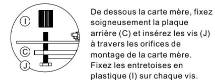
De dessous la carte mère, fixez soigneusement la plaque arrière (C) et insérez les vis (J) à travers les orifices de montage de la carte mère. Fixez les entretoises en plastique (I) sur chaque vis.
