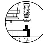
Assemblez les vis (E), les ressorts de retenue (G) et les clips de fixation avec les joints toriques en caoutchouc (H). Placez le waterblock assemblé sur le processeur et serrez-le sur chaque vis.
