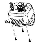
Fixez les clips de fixation AMD (B) sur le waterblock avec les vis (D).
