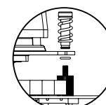
Assemblez les vis (E), les ressorts de retenue (G) et les clips de fixation avec les joints toriques en caoutchouc (H). Placez le waterblock assemblé sur le processeur et serrez-le sur chaque vis.
