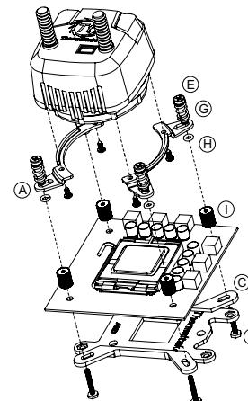
Avant l'installation, veuillez vérifier la plateforme du processeur et sélectionnez les orifices correspondant au socket de votre processeur.
