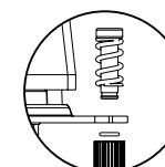
ネジ(E)、保持バネ(G)およびマウントクリップをゴムリング(H)でウォーターブロックと組み合せてCPUの上に設置し、各プラスチック製スペーサーに締め付けます。
