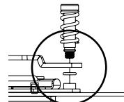
ネジ(E)、保持バネ(G)およびマウントクリップをゴムリング(H)でウォーターブロックと組み合せてCPUの上に設置し、マザーボードに締め付けます。
