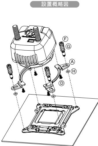
\*\*CPUに取り付ける前に、ウォーターブロックから保護カバーを取り外します。
