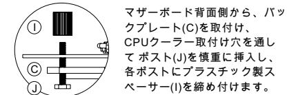
マザーボード背面側から、バックプレート(C)を取り付け、CPUクーラー取付け穴を通してポスト(J)を慎重に挿入し、各ポストにプラスチック製スペーサー(I)を締め付けます。
