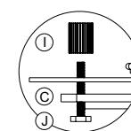
マザーボード背面側から、バックプレート(C)を取付け、CPUクーラー取付け穴を通してボスト(J)を慎重に挿し、各ボストにプラスチック製スパーサー(I)を締め付けます。
