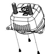
ねじ(D)でウォーターブロックにAMDマウントクリップ(B)を締め付けます。
