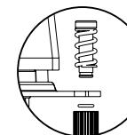
ネジ(E)、保持バネ(G)およびマウントクリップ(F)をゴムリング(H)でウォーターブロックと組み合せてCPUの上に設置し、各プラスチック製スペーサー(I)を締め付けます。
