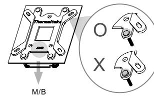
AMD CPUの取付け時にはバックプレートに刻印されている「AMD」の文字が見えるようにマザーボードへ取付けてください。
