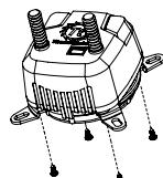
ねじ(D)でウォーターブロックにIntelマウントクリップ(A)を締め付けます。
