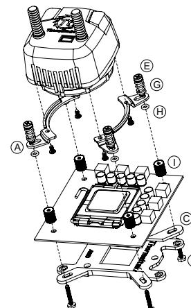
Перед установкой проверьте платформу ЦП и выберите отверстия, подходящие для используемого гнезда ЦП.
