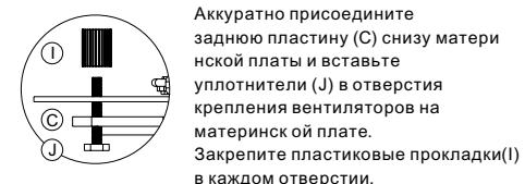
Аккуратно присоедините заднюю пластину (C) снизу материнской платы и вставьте уплотнители (J) в отверстия крепления вентиляторов на материнской плате. Закрепите пластиковые прокладки(I) в каждом отверстии.
