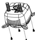
Закрепите крепежные клипсы (A) на водоблоке с помощью винтов (D).
