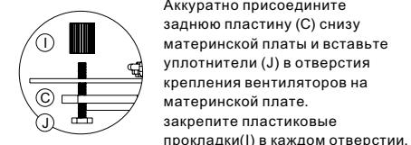
Аккуратно присоедините заднюю пластину (C) снизу материнской платы и вставьте уплотнители (J) в отверстия крепления вентиляторов на материнской плате. закрепите пластиковые покладки (I) в каждом отверстии.
