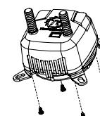
Закрепите крепежные клипы (A) на водоблоке с помощью винтов (D).
