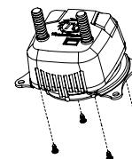
Закрепите крепежные клипсы (B) на водоблоке с помощью винтов (D).
