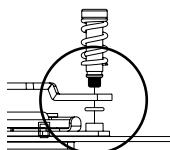
Соберите вместе винты (F), пружины (G) и также крепежные клипсы с резиновыми уплотнителями (H). Установите водоблок на ЦП и прикрутите его к материнской плате.
