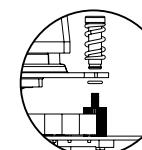
Соберите вместе винты (E), пружины (G) и также крепежные клипсы с резиновыми уплотнителями (H). Установите водоблок на ЦП и прикрутите его ко всем винтам.
