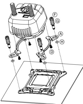
\*\*Перед установкой водоблока на ЦП, снимите с него защитную крышку.
