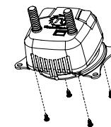
Aperte os cliques de montagem AMD (B) no bloco de água com parafusos (D).
