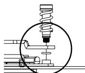
Monte os parafusos (F), as molas de retenção (G) e os cliques de montagem com os anéis de borracha (H). Coloque o bloco de água montado no CPU e aperte à motherboard.
