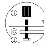
Por trás da motherboard, prenda com cuidado a placa traseira (C) e insira os postes (J) através dos orificios de montagem da motherboard. Aperte os espaçadores de plástico (I) sobre cada poste.
