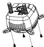
Aperte os cliques de montagem Intel (A) no bloco de água com parafusos (D).
