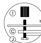
Por trás da motherboard, prenda com cuidado a placa traseira (C) e insira os postes (J) através dos orifícios de montagem da motherboard. Aperte os espaçadores de plástico (I) sobre cada poste.
