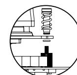
Monte os parafusos (E), as molas de retenção (G) e os cliques de montagem com os anéis de borracha (H). Coloque o bloco de água montado no CPU e aperte com cada parafuso.
