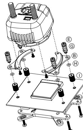
\*\*Remova a cobertura de protecção do bloco de água antes de fixar ao CPU.
