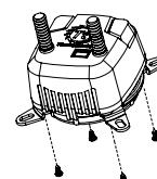
Aperte os cliques de montagem Intel (A) no bloco de água com parafusos (D).
