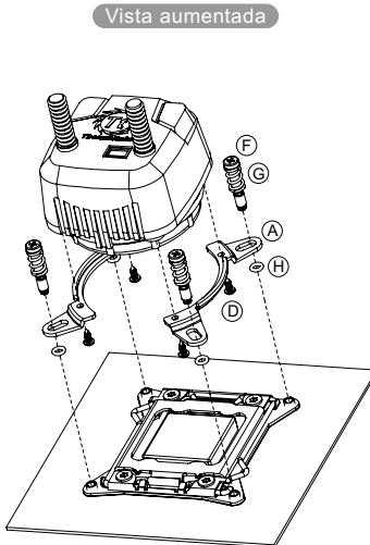
\*\*Remova a cobertura de protecção do bloco de água antes de fixar ao CPU.
