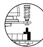
Monte os parafusos (E), as molas de retenção (G) e os cliques de montagem com os anéis de borracha (H). Coloque o bloco de água montado no CPU e aperte com cada parafuso.
