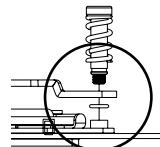
合螺絲(F)與彈簧(G),穿過扣具(A)後將橡膠圈(H)扣合在螺絲(F)下方的凹槽中。
