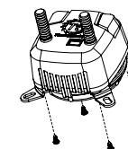
用螺絲(D)將二支INTEL扣具(A)固定於水冷頭上。
