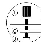
將4支長螺絲(J)穿過背板(C)和主機板,並用塑膠螺柱(I)對角均勻鎖緊。
