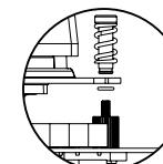
組合螺絲(E)與彈簧(G)，穿過扣具(A)後將橡膠圈(H)扣合在螺絲(E)下方的凹槽中。
