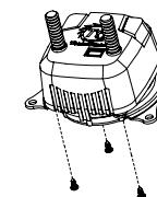
用螺絲(D)將二支AMD扣具(B)固定於水冷頭上。
