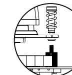
合螺絲(E)與彈簧(G),穿過扣具(B)後將橡膠圈(H)扣合在螺絲(E)下方的凹槽中。
