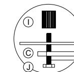
將4支長螺絲(J)穿過背板(C)和主機板，並用塑膠螺柱(I)對角均勻鎖緊。
