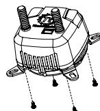
用螺絲(D)將二支Intel扣具(A)固定於水冷頭。
